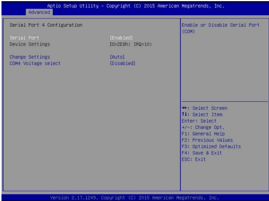
Figura 3-11. Tela da configuração da porta serial 4
