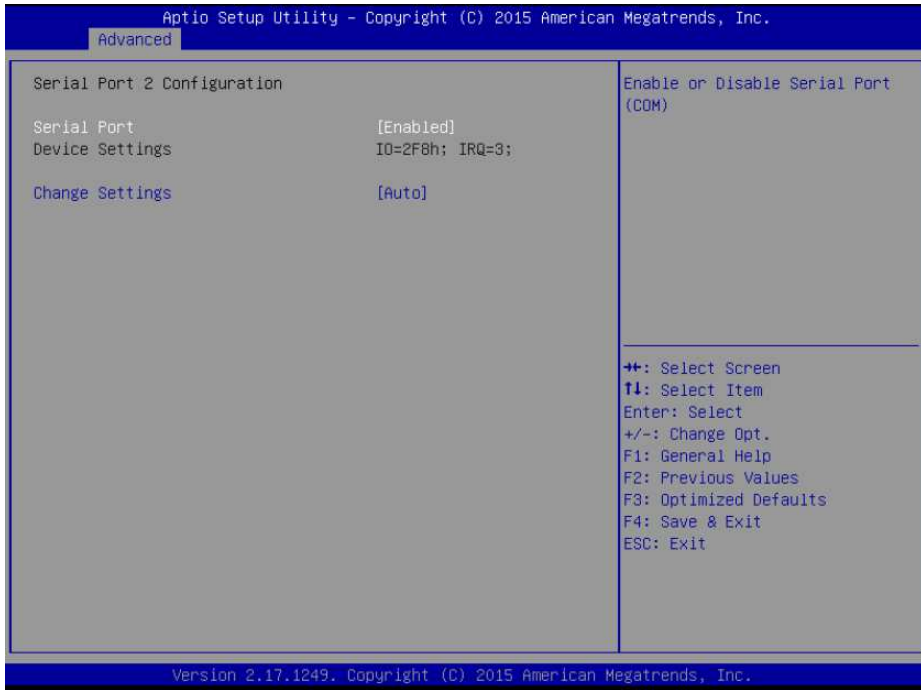
Figura 3-9. Tela da configuração da porta serial 2
